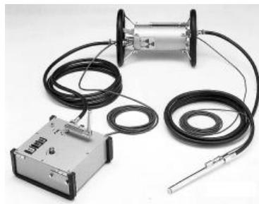
Ir-192非破壊検査装置
