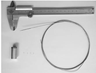
線源：右側のワイヤの先端部にIrが封入されている
