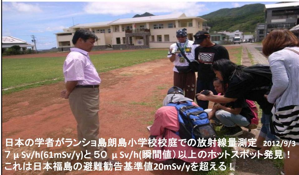
日本側測定では、 $7\mu\text{Sv/h}$ ( $61\text{mSv/y}$ )と $50\mu\text{Sv/h}$ (瞬間値)以上のホットスポット発見！ これは日本の避難勧告基準値 $20\text{mSv/y}$ を超える！
