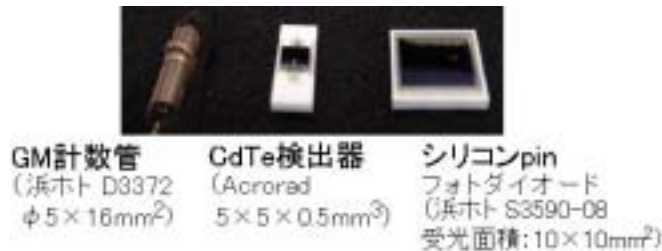
図6 エネルギー特性実験使用の検出素子<5>
