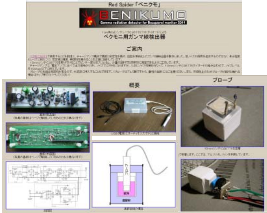
図 18a CsIシンチレータとフォトダイオードによるベクモニ用ガンマ線検出器
